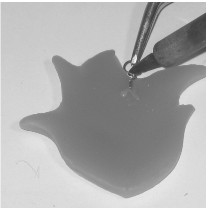
Abbildung 10.5: Hält man die Öse mit einer Zange fest, kann man sie mit einem Lötkolben erwärmen und in das Wachs hinein drücken.
